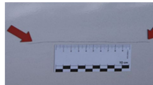
Zadrapania > 20 mm UWAGA: Na tylnych drzwiach wahadłowych nie można pomalować jedynie połowy panelu
