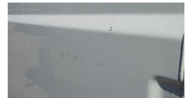
Zadrapania > 20 mm UWAGA: Na tylnych drzwiach wahadłowych nie można pomalować jedynie połowy panelu
