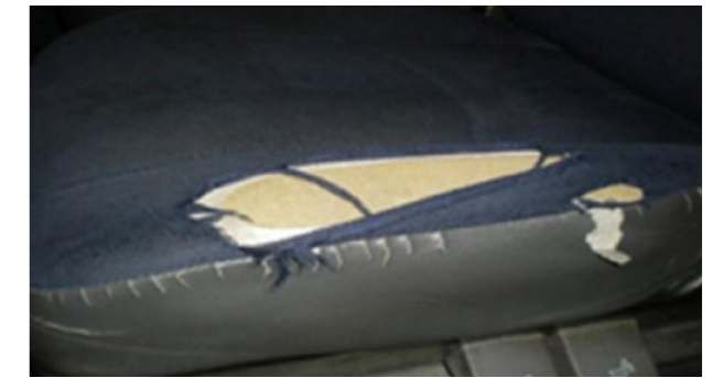
Wypalenia > 3 mm, perforacja lub naderwanie osłony, pianka nienaruszona
