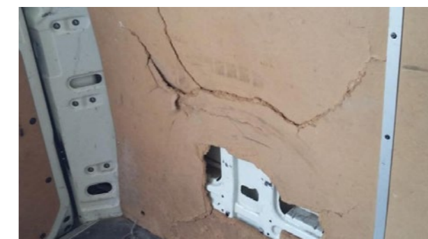
Wewnętrzne osłony drewniane: Ślady uderzeń, rozdarty panel, brak panelu (nie dotyczy górnych paneli drzwiowych)
