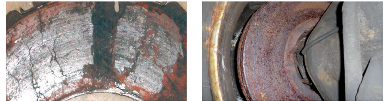
Zardzewiałe, zużyte tarcze hamulcowe
