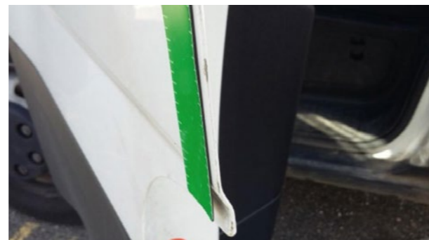
Odprysk na krawędzi drzwi
