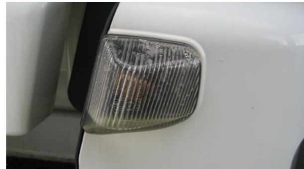
🔄 Zadrapanie w polu świecenia, pęknięcie, kondensat, ułamanie lub złamane mocowanie
