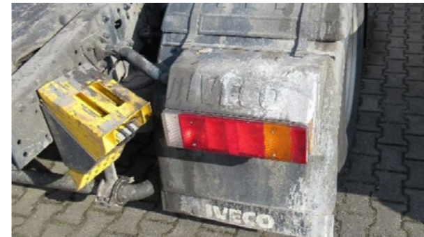
Głębokie przebarwienia z powodu pierwiastków chemicznych
