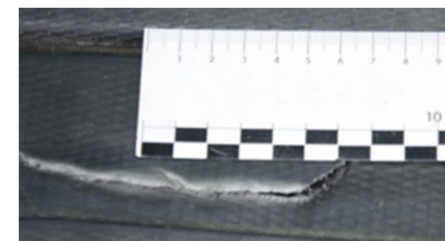
Perforacja elementów wykończeniowych z twardego plastiku. Naprawa elementów wykończeniowych z twardego plastiku za zryczałtowaną stawkę godzinową, jeśli jest akceptowalna pod względem estetycznym i nadająca się do naprawy
