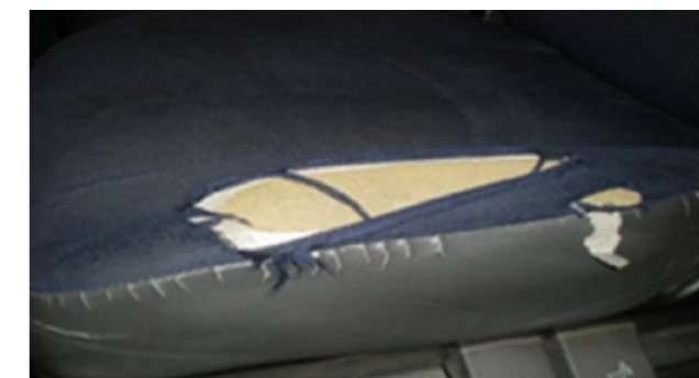
Wypalenia > 3 mm, perforacja lub naderwanie osłony, pianka nienaruszona
