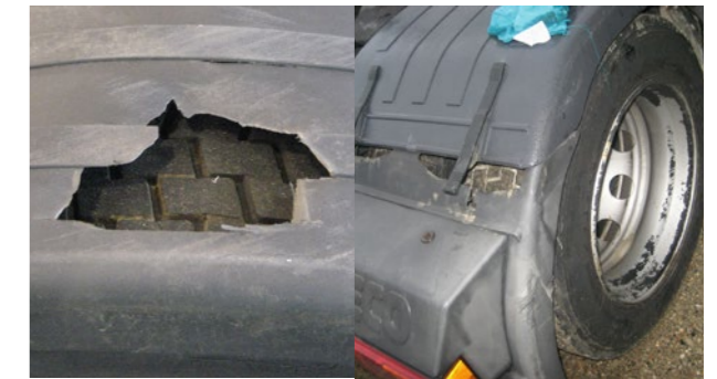
Ubytek materiału, uszkodzona część
