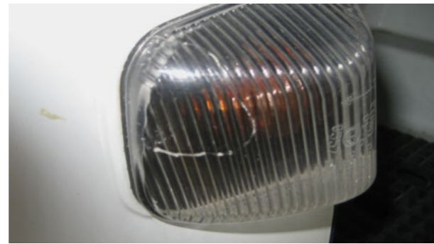
🔄 Pęknięte światła tylne i przednie
