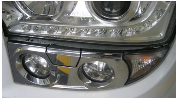
🔄 Zadrapanie w polu świecenia, pęknięcie, kondensat, ułamanie lub złamane mocowanie
