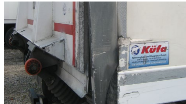
🔧 Seitliche und hintere Türen: Erhebliche Verformung: Reparaturzeit >1 h, kann auf wirtschaftliche Weise repariert werden, Verschluss nicht versiegelt
