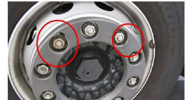
Radabdeckungen: Verformt, gebrochen, Material fehlt oder entfernt
