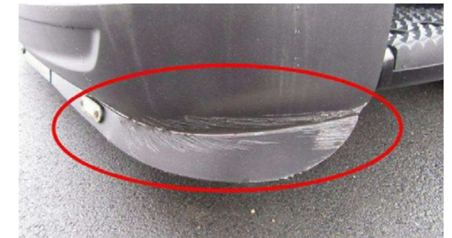
☰ Materialabtrag oder Verformung möglich oder wirtschaftlich reparierbar
