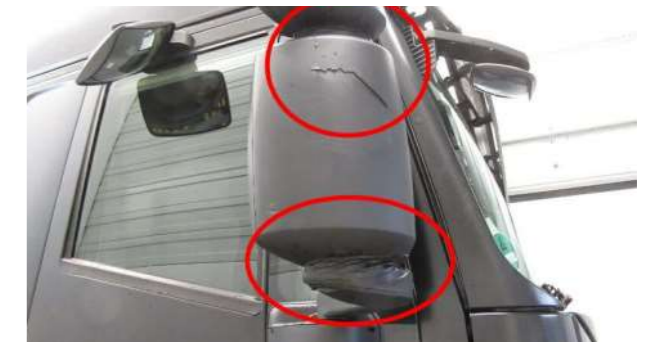
☰ Materialabtrag oder Verformung möglich oder wirtschaftlich reparierbar
