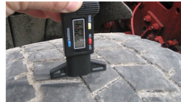
Reifen: Reifenverschleißanzeige > 3 mm, abgetragen
