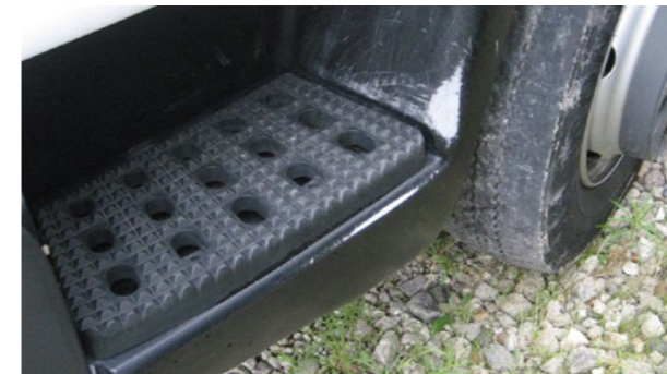
☰ Kratzer > 45 \text{ cm}^2 (entspricht der Fläche einer Kreditkarte), oder die mit dem Fingernagel zu spüren sind
