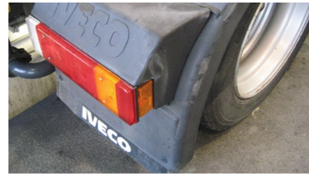
Tiefe Kratzer und Verformungen
