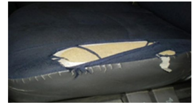
Brandlöcher > 3 mm, Löcher oder Risse im Bezug ohne Beschädigung der Polsterung
