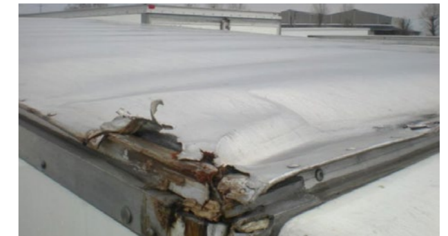
↻ Dachfläche: Rahmen beschädigt, Leder kann nicht auf wirtschaftliche Weise repariert werden
