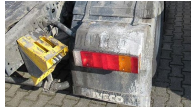
Starke Verfärbung durch chemische Elemente
